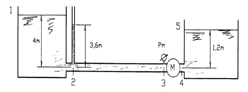
Para iniciar o problema nós devemos achar o sentido do escoamento, lembrando que em um trecho sem máquina o escoamento ocorre da carga maior para a carga menor.
