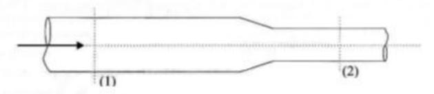
**Resp.:**  $v_2 = 26,7 \text{ m/s}$ ;  $Q_m = 2,4 \times 10^{-2} \text{ kg/s}$ ;  $Q_1 = 0,02 \text{ m}^3/\text{s}$ ;  $Q_2 = 0,0261 \text{ m}^3/\text{s}$ ;  $Q_0 = 0,24 \text{ N/s}$
