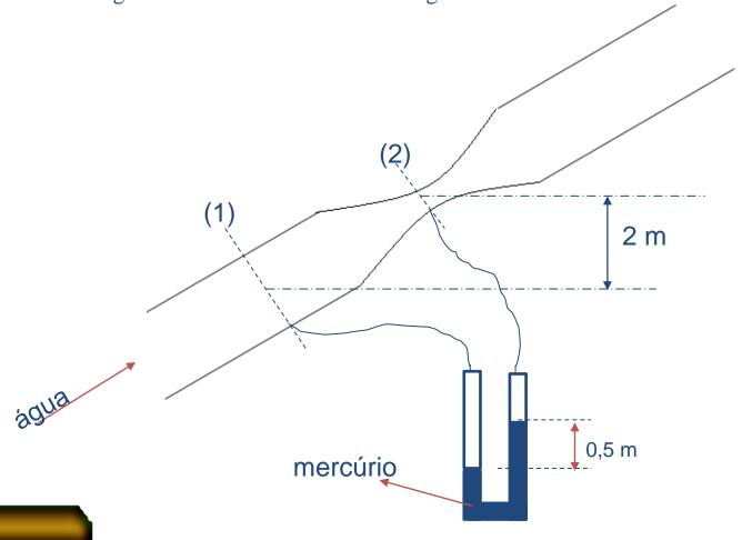
Em uma instalação hidráulica instalou-se um medidor de vazão do tipo Venturi para estimar a vazão de escoamento da água na instalação. Sabendo-se que Ø máx. do Venturi é igual a 20 mm, Ø garg do Venturi é igual 10 mm. Desnível do mercúrio no manometro diferencial 20 cm e que o coeficiente de vazão do venturi e 0,95 pede-se:
