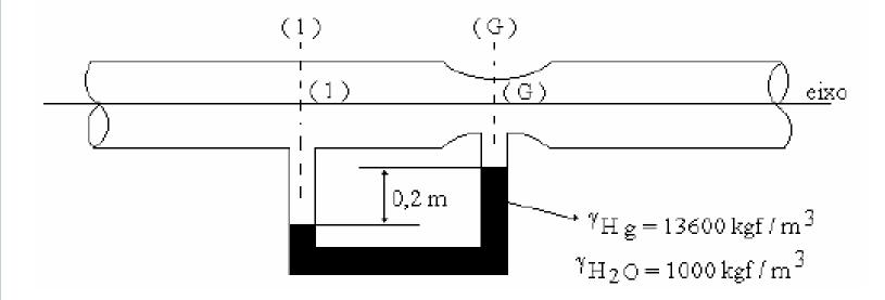
Para se medir a pressão absoluta de um gás ( $p_{gás\_abs}$ ) usa-se um manômetro que consiste de um tubo em forma de U contendo mercúrio ( $\gamma_{Hg} = 136000 N/m^3$ ). Com base na figura e sendo a pressão atmosférica igual a 700 mmHg, determine  $p_{gás\_abs}$ .
