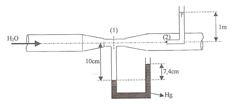
Sabendo que o Venturi a seguir tem um coeficiente de vazão igual a 0,98, pede-se determinar a vazão real do escoamento, são dados:  $A_1 = 10 \text{ cm}^2$ ;  $A_2 = 5 \text{ cm}^2$ ;  $\gamma_{\text{água}} = 1000 \text{ kgf/m}^3 \text{ e } \gamma_{\text{Hg}} = 13600 \text{ kgf/m}^3$
