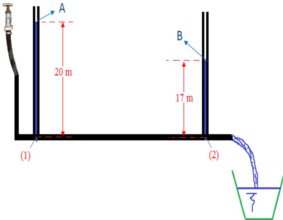
E calculamos a vazão do escoamento de forma direta
