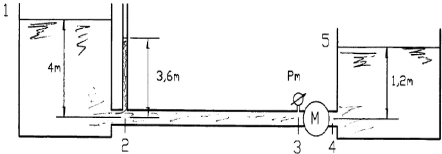
Para iniciar o problema nós devemos achar o sentido do escoamento, lembrando que em um trecho sem máquina o escoamento ocorre da carga maior para a carga menor.
