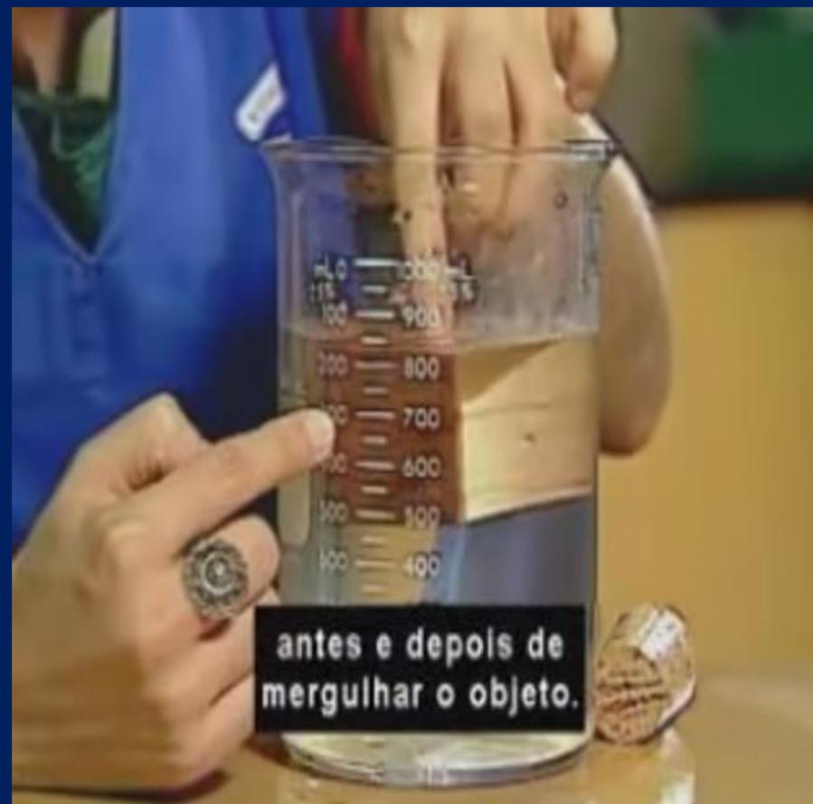
Importante observar que o corpo estando totalmente imerso só existe duas forças atuando sobre ele que seriam o “empuxo” e o PESO DO CORPO:
