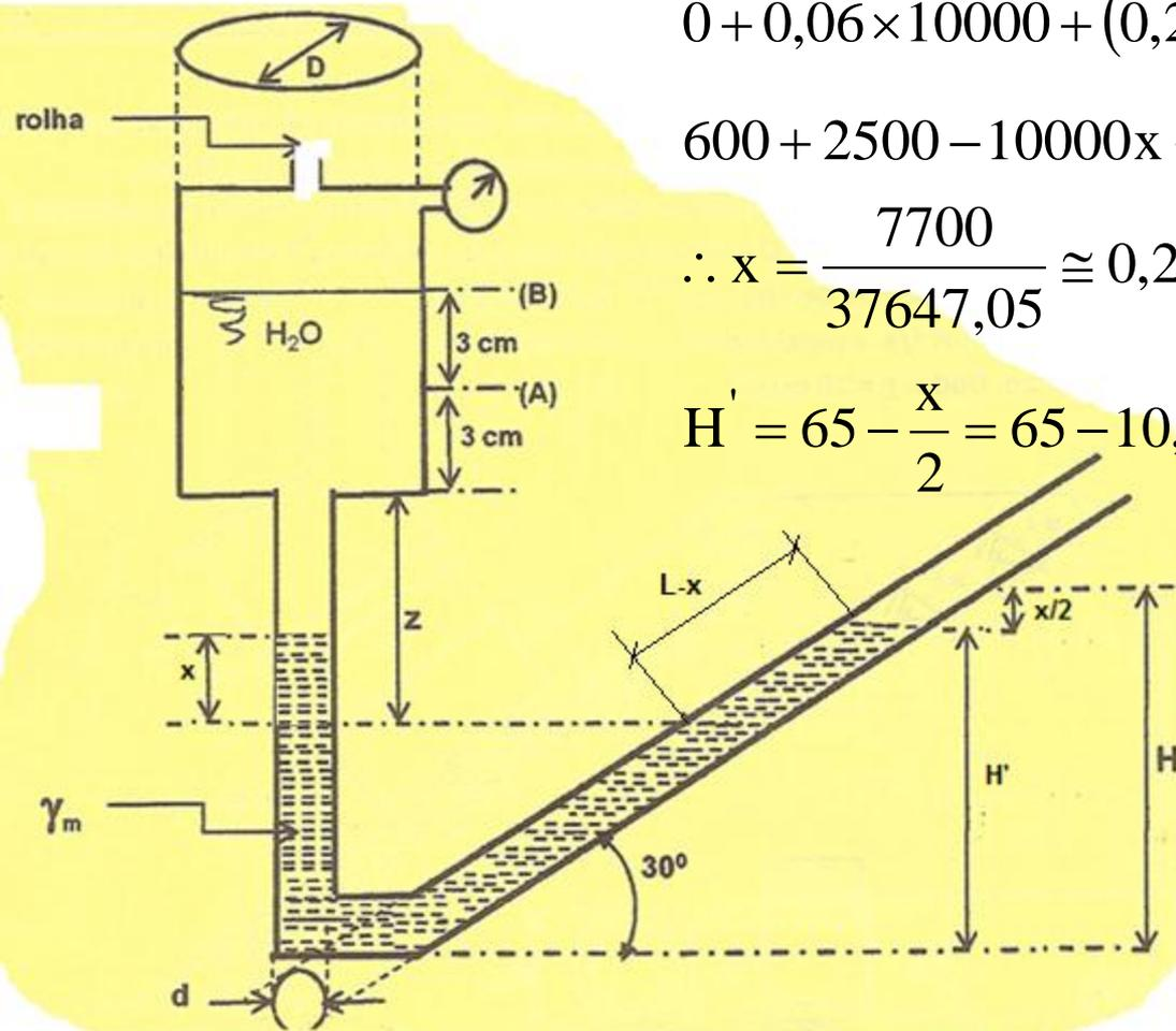
Na figura, a superfície da água está em (A) pois neste nível a pressão absoluta do AR é de 104 KPa abs. Nesta condição a leitura L é de 68 cm, a leitura no manômetro metálico é de 0,8 mca e a cota z de 25cm. Ao retirar a rolha, a superfície da água passa para o nível (B). Sendo o peso específico da água de 10 N/litro, o peso específico do mercúrio de 136 N/litro e o diâmetro do reservatório D = 13 cm.
