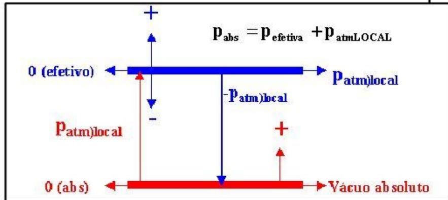
O barômetro (aparelho para medir a pressão atmosférica local) trabalha na escala absoluta.
