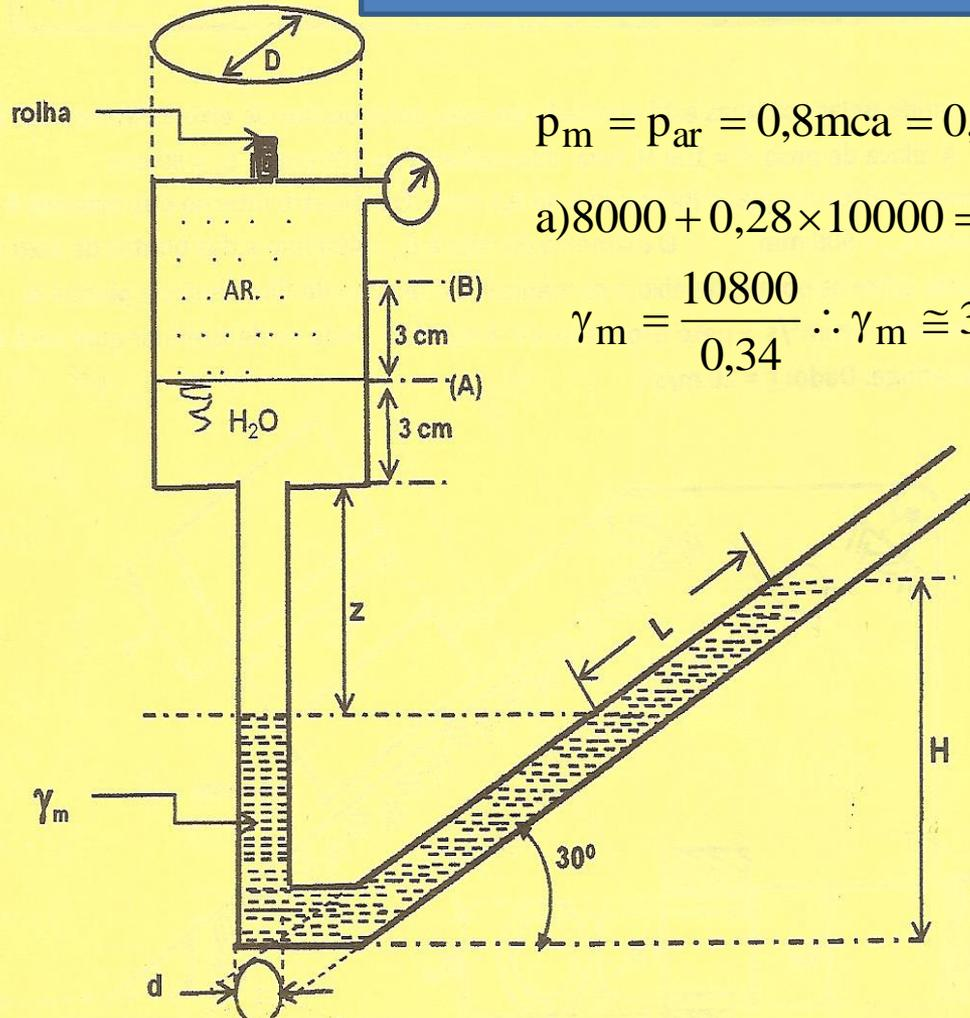
$$p_m = p_{ar} = 0,8 \text{ mca} = 0,8 \times 10000 = 8000 \frac{\text{N}}{\text{m}^2} \text{ (ou Pa)}$$
