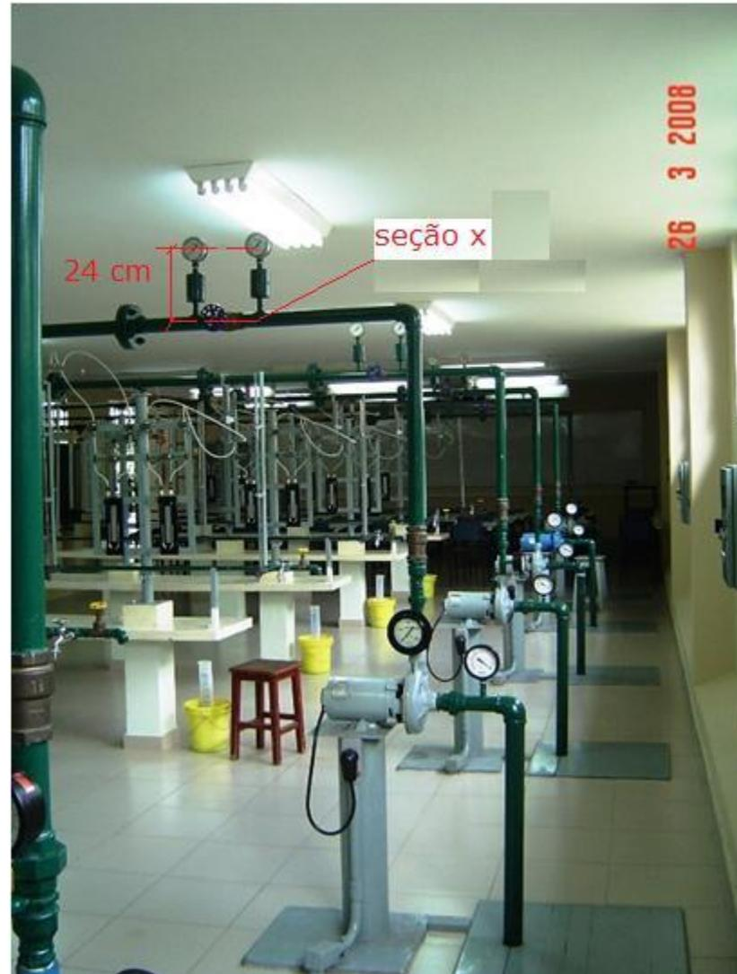
CONSIDERE QUE A SEÇÃO X É UMA DAS SEÇÕES DE UM TUBO DE AÇO "40 DE DIÂMETRO NOMINAL 1,5", PORTANTO COM DIÂMETRO INTERNO DE 40,8 mm E ÁREA DE SEÇÃO LIVRE IGUAL A 13,1 cm<sup>2</sup>. O FLUIDO QUE ESCOA É A ÁGUA A 20 GRAUS CELSIUS ONDE SE TEM SUA MASSA ESPECÍFICA IGUAL A 998,2 kg/m<sup>3</sup>. CONSIDERE A ACELERAÇÃO DA GRAVIDADE IGUAL A 9,8 m/s<sup>2</sup>.
