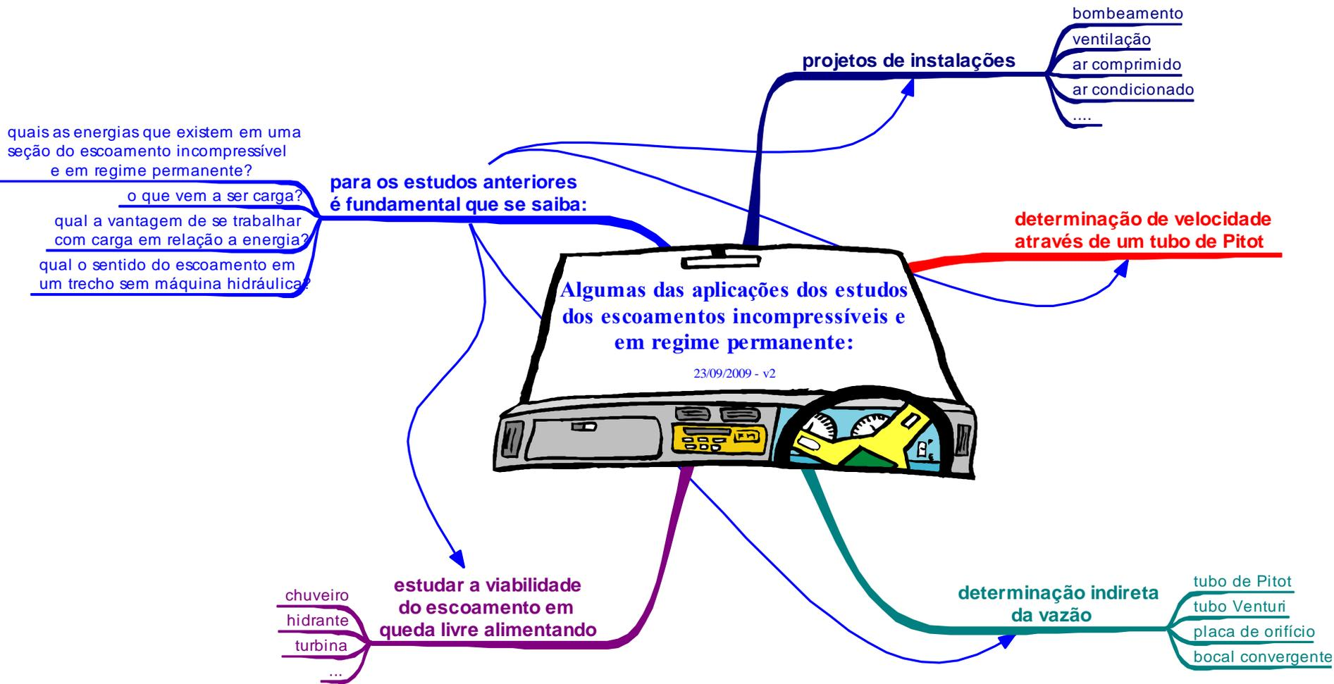
Para o estudo de todas as aplicações anteriores deve-se efetuar um balanço de energias entre duas seções do escoamento, o que é viabilizado pela aplicação da equação da energia.
