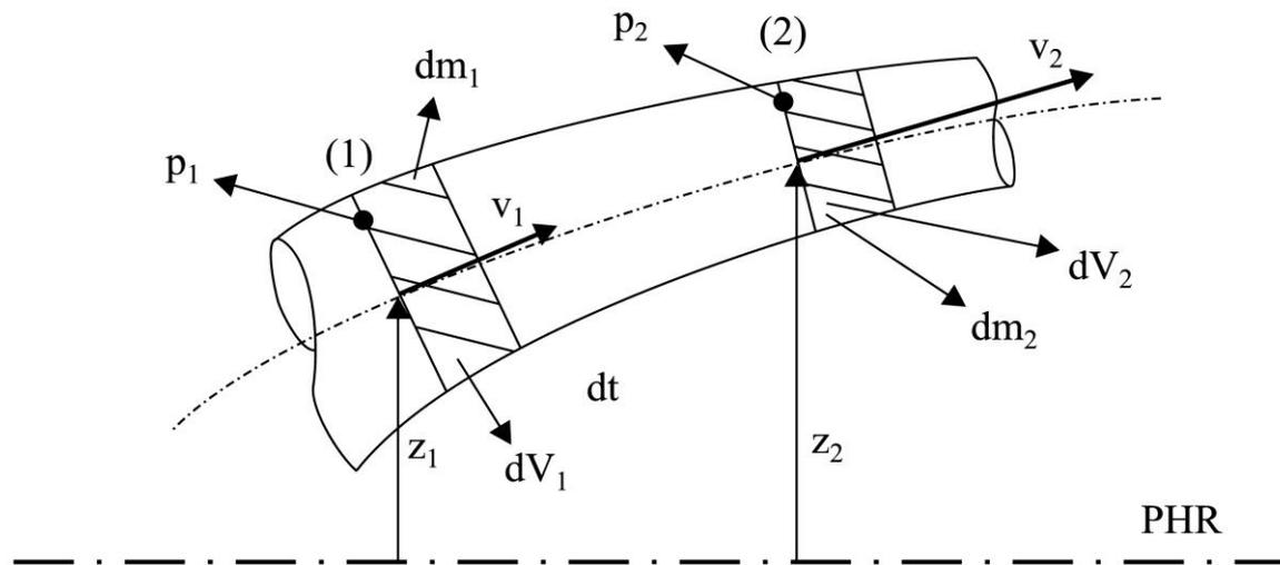
$$dm_1gz_1 + \frac{dm_1v_1^2}{2} + p_1dV_1 = dm_2gz_2 + \frac{dm_2v_2^2}{2} + p_2dV_2$$
