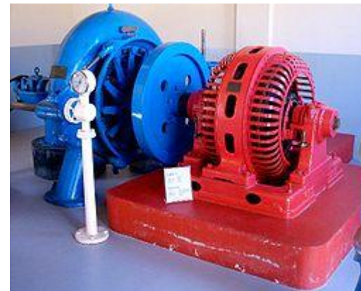
Turbina Francis da Voith (azul) acoplada a gerador Westinghouse de 117,6 kW (vermelho)
