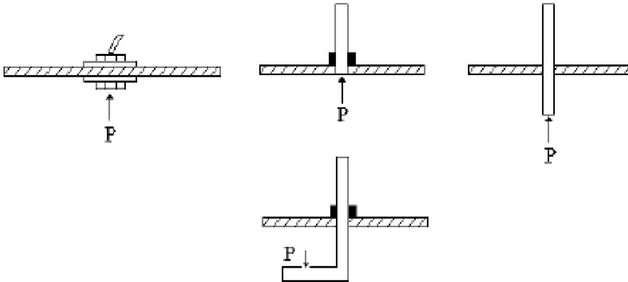
Pressão dinâmica é determinada com a transformação da energia cinética em energia de pressão.
