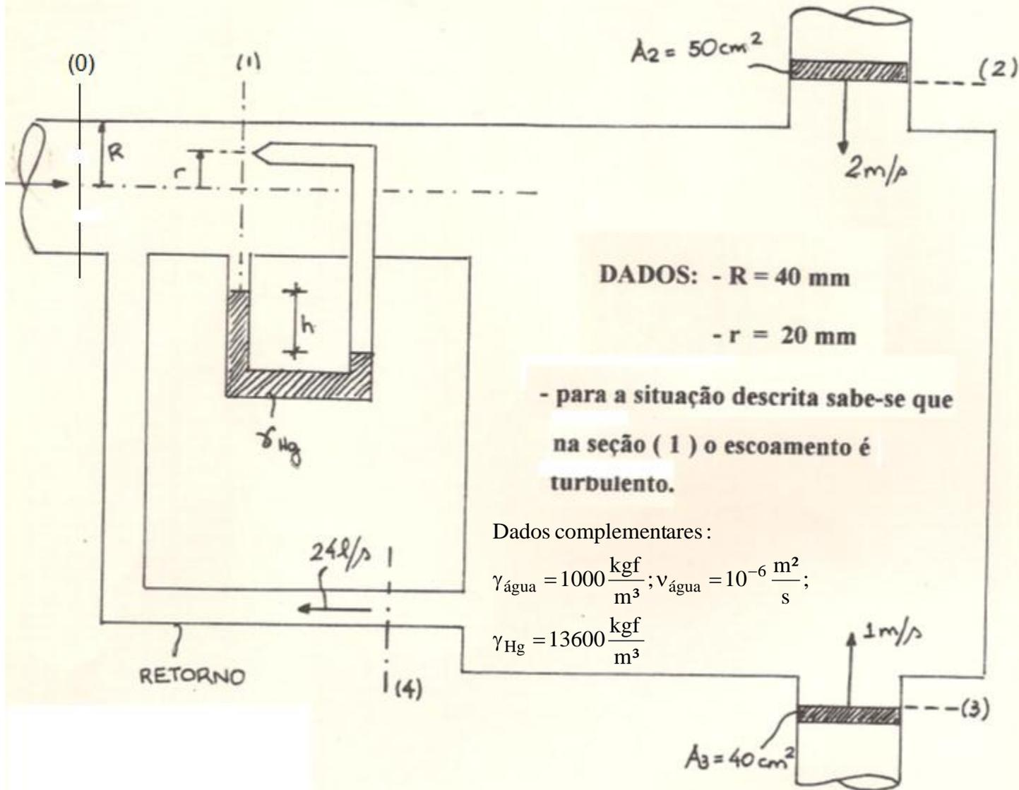
3ª QUESTÃO : O ESQUEMA A SEGUIR REPRESENTA UM TRECHO DE UMA INSTALAÇÃO HIDRÁULICA ONDE (VALOR 2,5) TODAS AS TUBULAÇÕES SÃO FORÇADAS E DE SEÇÃO TRANSVERSAL CIRCULAR. PEDE-SE :
