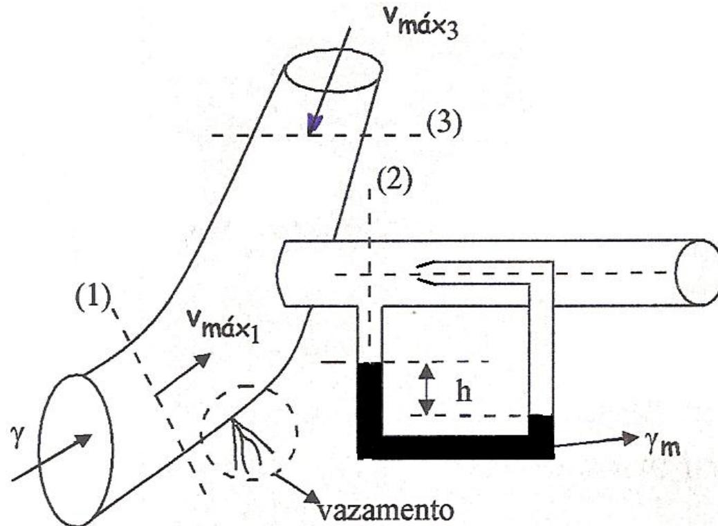
2 Considerando o esquema abaixo pede-se determinar o desnível do fluido manométrico utilizado no manômetro diferencial acoplado ao tubo de Pitot e verificar se o sentido indicado para a seção (0) está correto.
