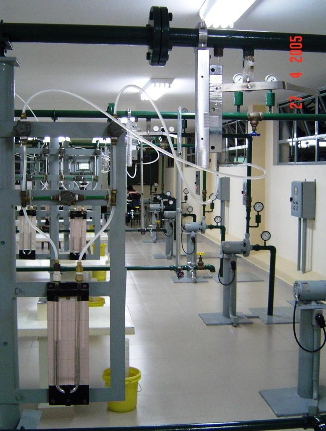
Instalação do tubo de Pitot na bancada do laboratório, onde o manômetro diferencial em forma de U permite a determinação da pressão dinâmica, isto porque em um de seus ramos atua a pressão total e no outro a pressão estática
