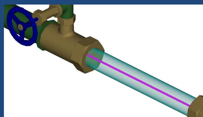
TRECHO ONDE OCORREM OS ESCOAMENTOS, ONDE DETERMINAMOS A VAZÃO E ONDE VISUALIZAMOS OS TIPOS DE ESCOAMENTO INCOMPRESSÍVEIS.
