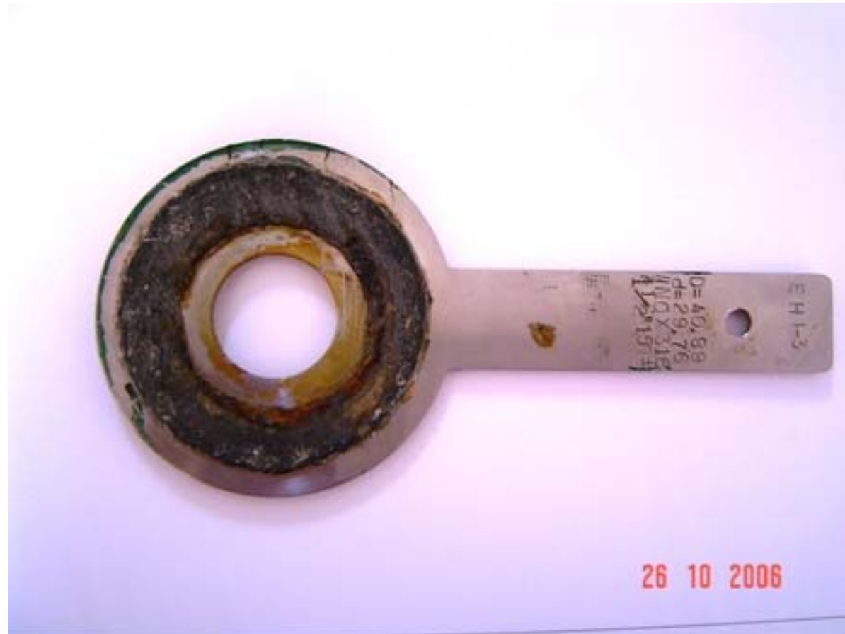
Placa de orifício utilizada em bancada do Centro Universitário da FEI
