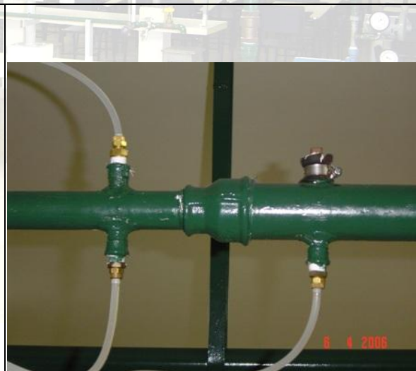
Seção (3), redução de 1,5" para 1" e seção (4). O desnível do mercúrio no manômetro em U instalado entre as seções (3) e (4) é denominado de h_{3-4} .
