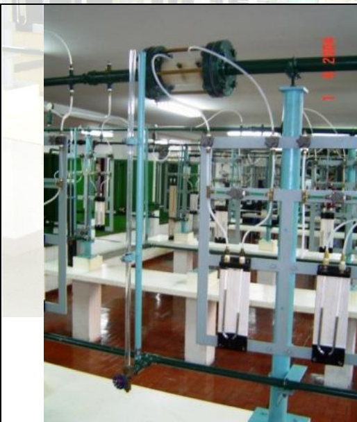
Seção (3), redução de 1,5" para 1" e seção (4). O desnível do mercúrio no manômetro em U instalado entre as seções (3) e (4) é denominado de h_{3-4} .
