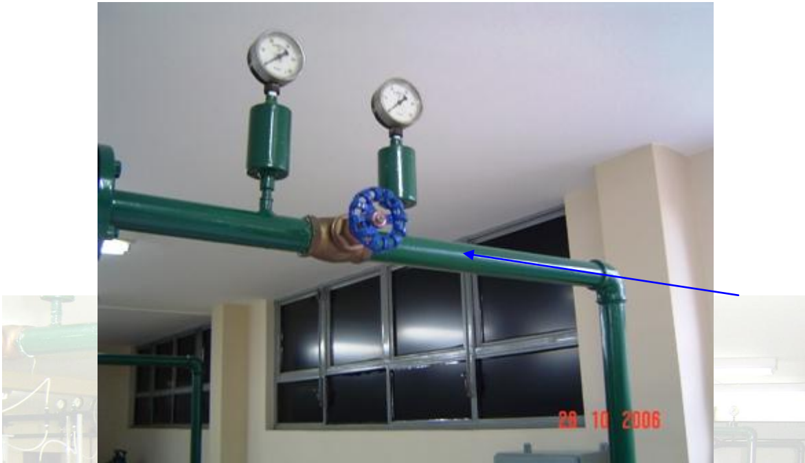
Seção (1), válvula globo e seção (2). A cota do centro do manômetro até o eixo do conduto é denominada de h_1 .
