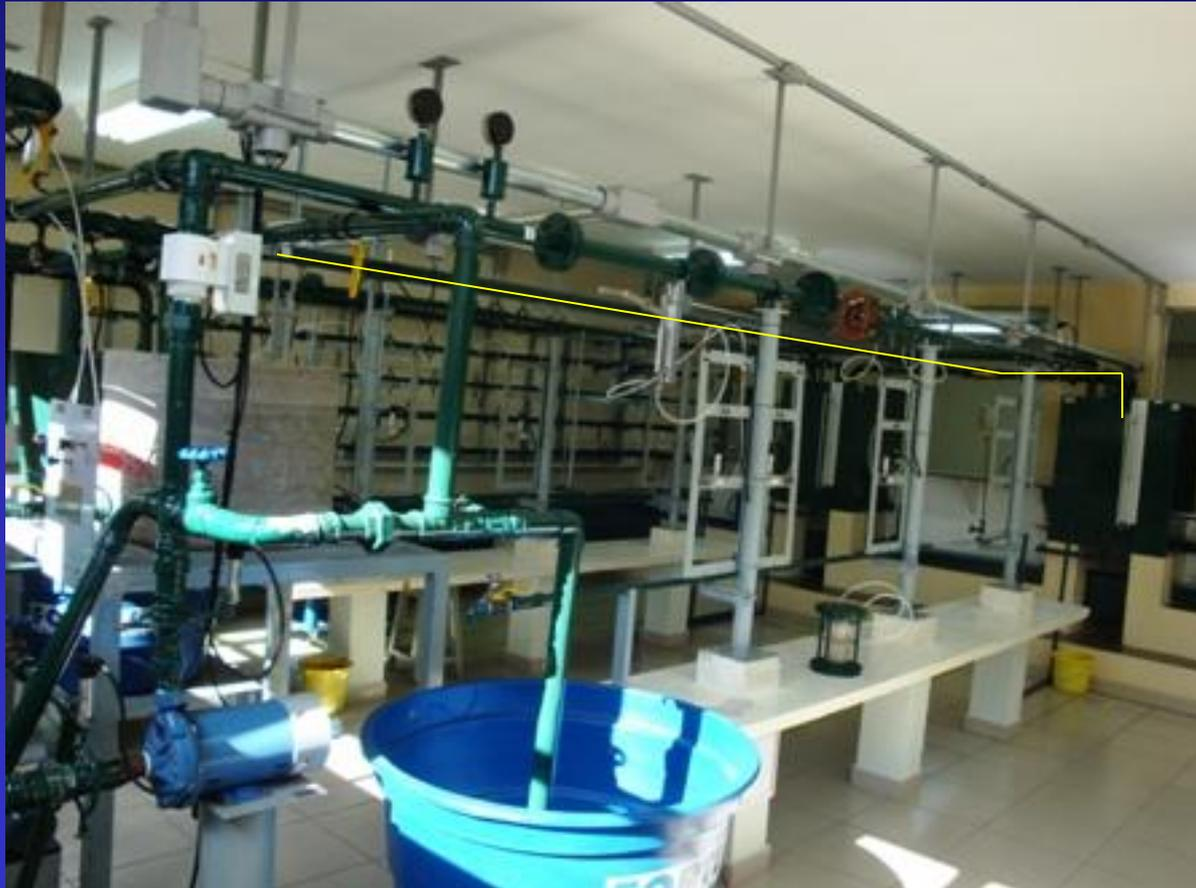
A seguir é fornecida a isométrica de uma das possibilidades da associação em série das bombas das bancadas 7 e 8 do laboratório de mecânica dos fluidos do Centro Universitário da FEI, onde adotando-se o plano horizontal de referência no nível de captação se tem
