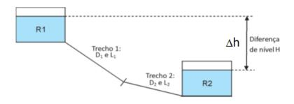
Pede-se a expressão para o cálculo da vazão em queda livre em função de uma constante numérica que deve ser especificada, da diferença do nível H ( $\Delta h$ ), dos coeficientes de perda de carga distribuída e dos dados anteriores  $L_1$ ,  $L_2$ ,  $D_1$  e  $D_2$ . (valor – 1,5)
