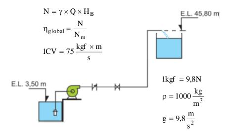
**Dados:** o rendimento do grupo motor-bomba é 0,8; a vazão a ser recalcada é 0,5 L/s do reservatório inferior até o reservatório superior, conforme a figura; a perda de carga total para a sucção é 0,85 m; a perda de carga total para o recalque é 2,30 m e que a carga cinética na saída é desprezível.
