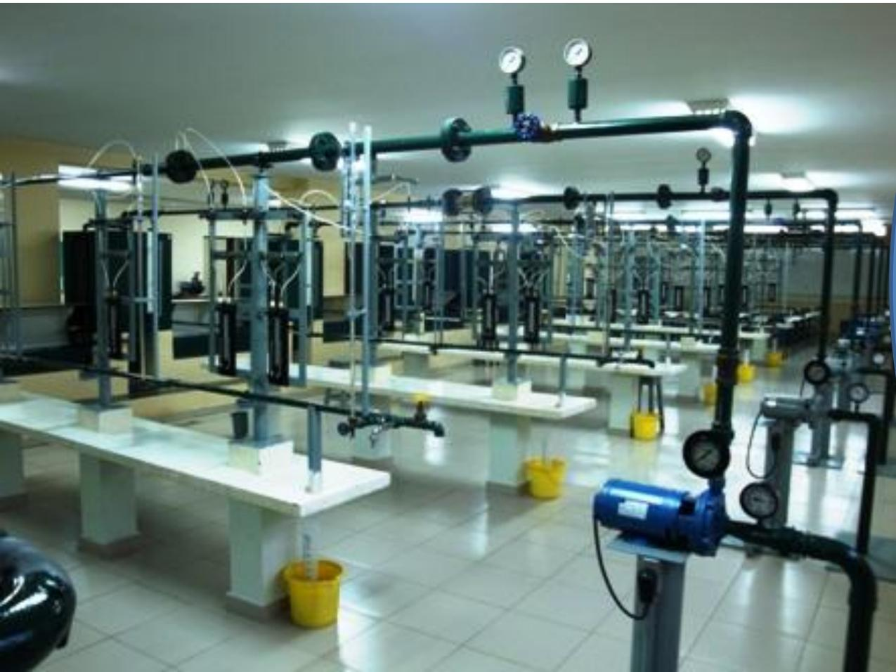
Os monitores afirmaram que a leitura do manômetro metálico a jusante da válvula globo de 1,5" não está correta para a vazão máxima. Considerando que a leitura do manômetro metálico a montante da válvula gaveta de 1" está correta, bem como os desníveis do mercúrio nos manômetros diferencias em U, verifique se a afirmação dos monitores é correta justificando.
