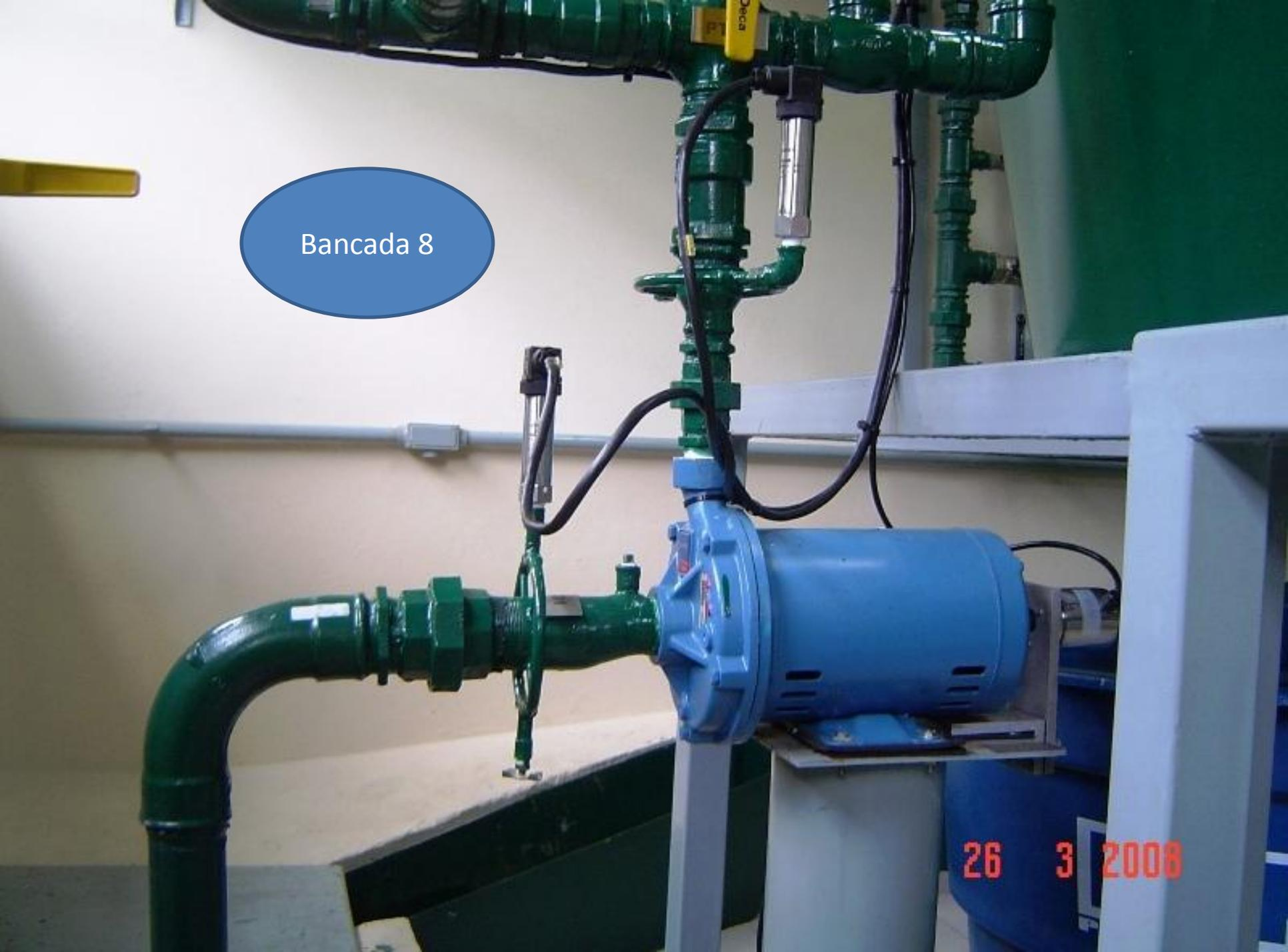
A determinação da carga manométrica em função da vazão do escoamento é obtida através da equação da energia aplicada entre a entrada e saída da bomba, onde as perdas não são consideradas nesta equação, já que foram consideradas no rendimento da bomba.
