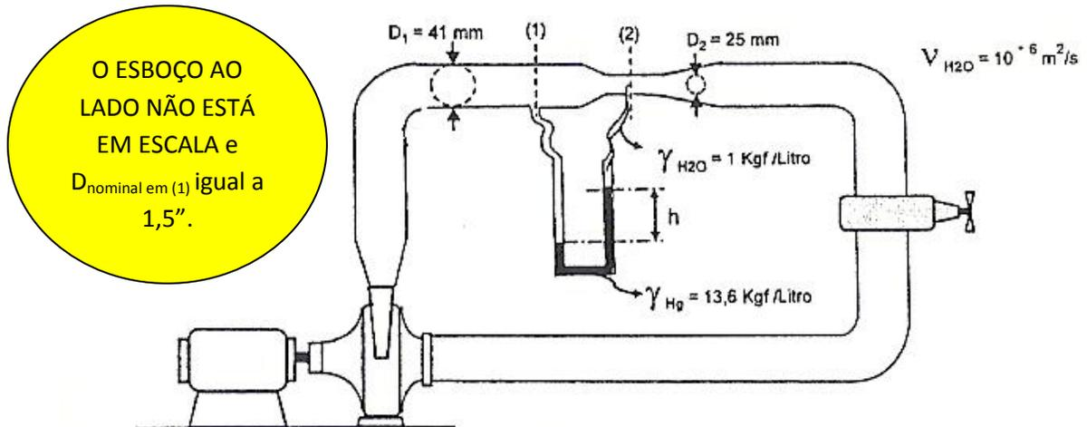
“O tubo venturi e a bomba centrífuga foram ensaiados num laboratório, de forma que os dados obtidos geraram os diagramas que seguem. Pede-se determinar a altura manométrica da bomba para uma leitura do desnível no manômetro  $h = 95$  mm. (indicar nos diagramas como obteve os valores)”
