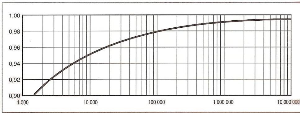
Figura 17.9 – Valores do coeficiente  $k$  em função do número de Reynolds (escala logarítmica)
