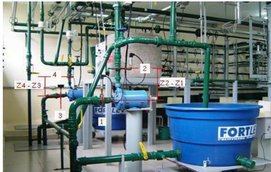
Considerando o funcionamento da bomba B8 no transporte d'água para o tanque 8 com o escoamento através da própria bancada, pede-se especificar a sua potência para a vazão de 16 m<sup>3</sup>/h.
