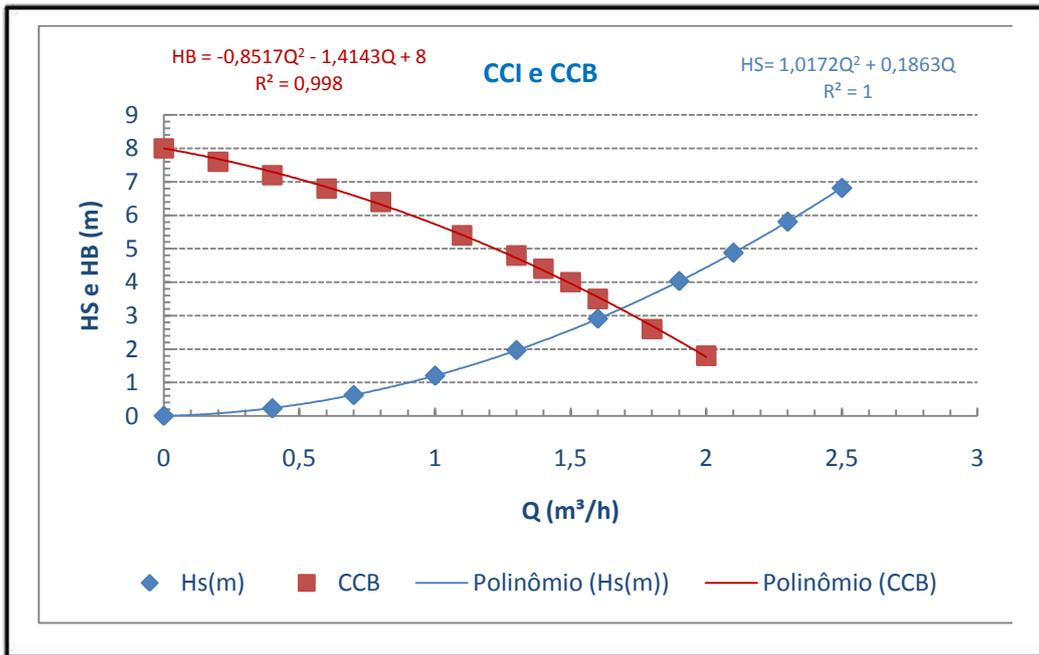
Pede-se especificar a vazão e a carga manométrica do ponto de trabalho do exemplo anterior, sabendo-se que o fluido transportado é a água a 26°C e que o rendimento no ponto de trabalho é 68%, calcule a potência da bomba no ponto de trabalho.
