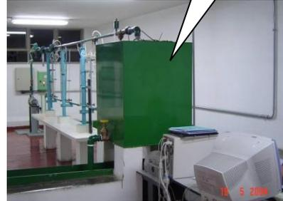
Determinação da vazão máxima da bancada 8 alimentando o tanque 8 pelo painel de controle.
