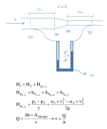
Nas determinações anteriores estabeleceremos que a vazão seja a mesma tanto na determinação do "f" como na determinação do " $K_S$ " já que isto facilitará a determinação dos mesmos.
