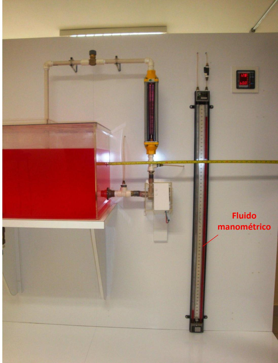
O fluido manométrico é uma mistura da isoparafina 13/15 com bromofórmio e com corante e as suas densidades foram determinadas no CLM.
