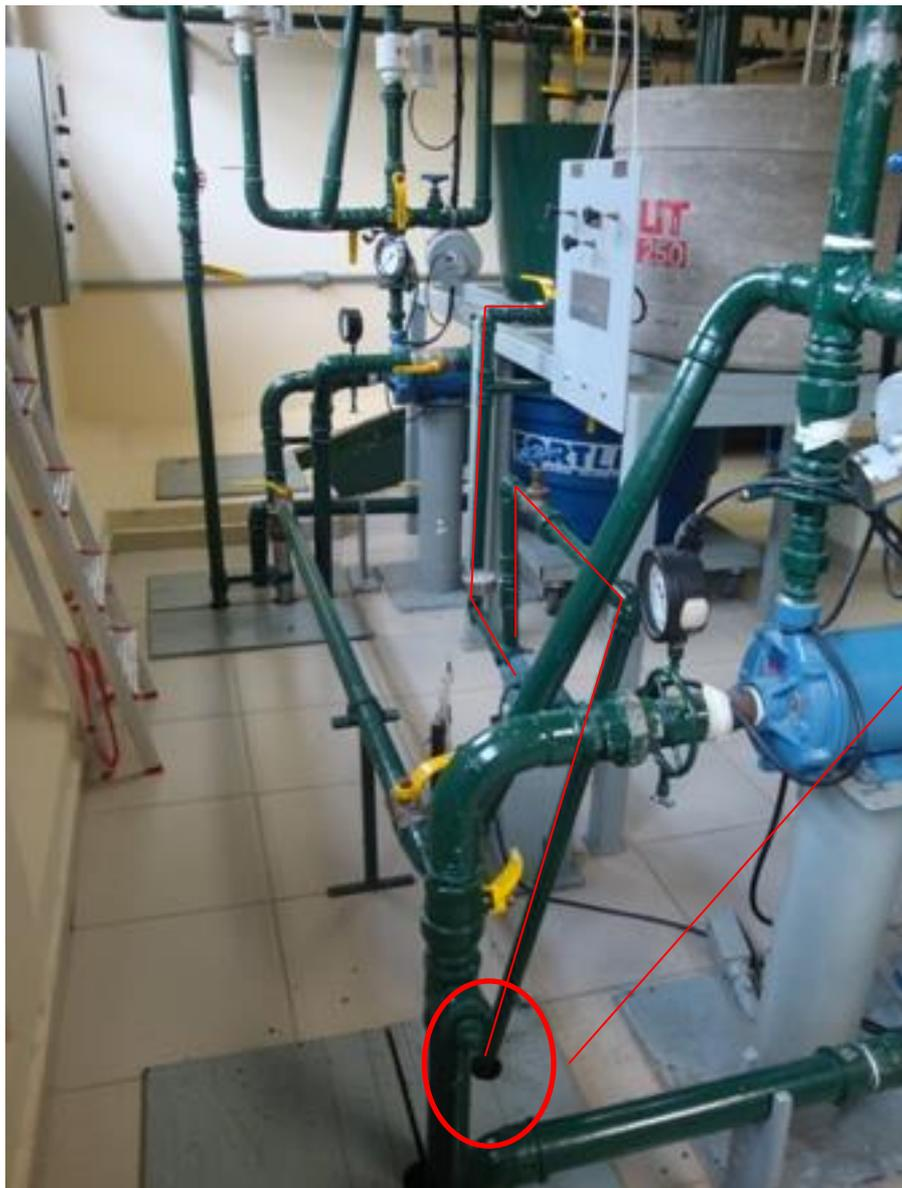
Retirar a tampa para caracterizar a seção final como sendo a saída do tubo de PVC e considerar o PHR no chão do laboratório.
