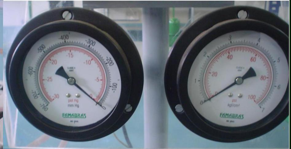
Com a válvula controladora de vazão totalmente fechada se obtém as coordenadas do ponto de shut-off, para tal, deve-se anotar as pressões manométricas respectivamente na entrada e saída da bomba e a rotação do conjunto motor bomba. Observe que:
