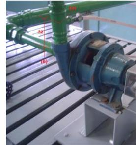
A seção de entrada e a de saída, pertencem a tubos de aço 40 com diâmetros nominais de 1,5" e 1" respectivamente
