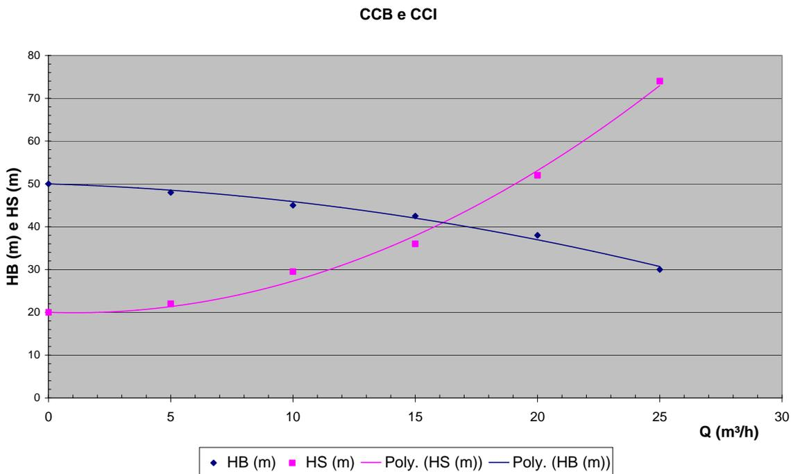
**Dados:** Singularidades da instalação a seguir: válvula de pé com crivo (Leq = 20 m); cotovêlos de raio médio (Leq = 2m para cada um); válvula de retenção tipo leve (Leq = 4m); válvula globo aberta (Leq = 10m) e entrada normal de reservatório (Leq = 1 m); leitura barométrica – 700 mm Hg; fluido a ser transportado – água com peso específico igual a 996,4 kgf/m³; aceleração da gravidade – 9,8 m/s² e diâmetros internos de sucção e recalque iguais a 50 mm.
