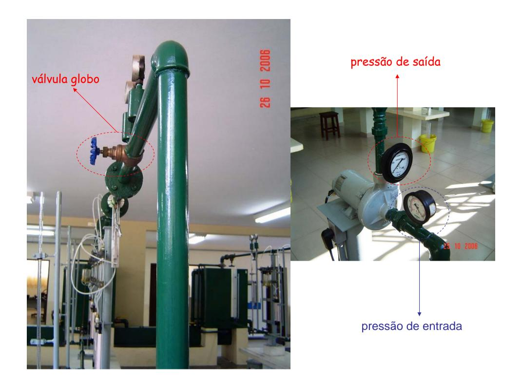
A rotação será diferente em cada leitura, diferente de 3500 rpm, que foi a rotação especificada pelo fabricante. Esta diferença de rotação é devido ao escorregamento e a variação de tensão na rede elétrica. A rotação deve ser lida pelo tacômetro.
