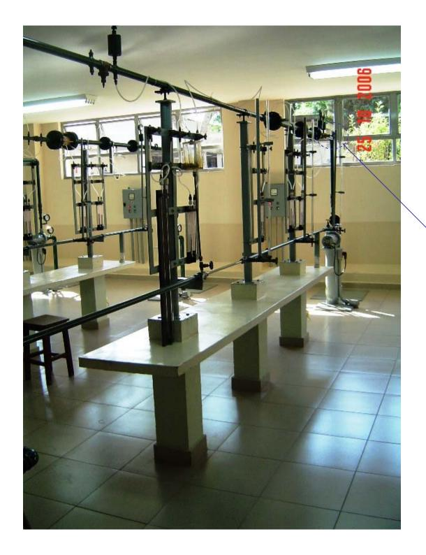
A bancada de laboratório representa uma instalação de recalque.
