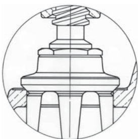
Figura 30: Obturador para Válvula Globo acima DN 40 Disco cônico metálico com guias e sede integral
